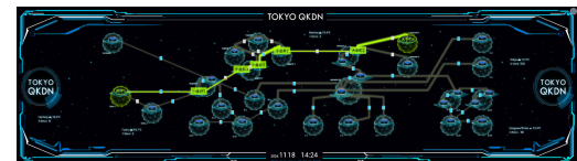
東京QKDネットワークの監視画面
